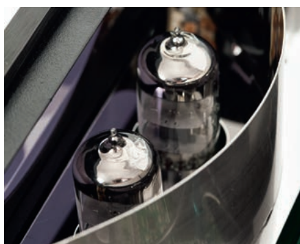
Esencją przedwzmacniacza są triody; komorę lamp dodatkowo podświetlono systemem diod.
